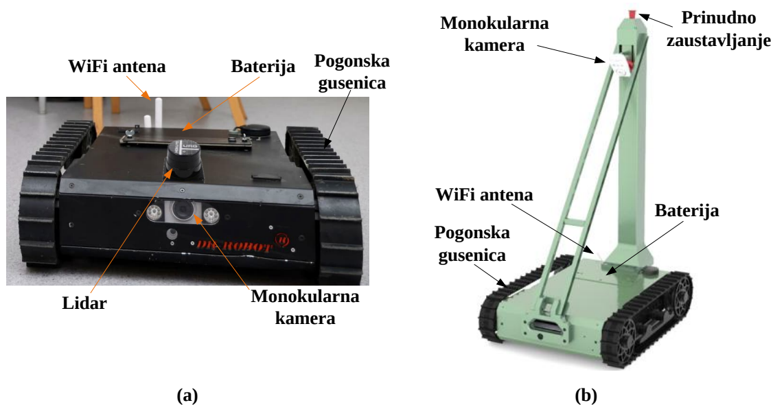
Slika 3.23: Laboratorijsko gusenično vozilo: a) osnovna struktura vozila primenjena u zadatku praćenja lidera, b) modifikovana struktura, primenjena u zadatku praćenja vozne trake sa izbegavanjem prepreka.
